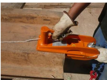
Verrouiller l'axe par une simple rotation à 180°.
