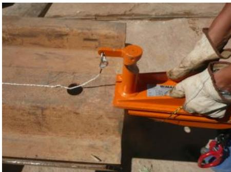
Déverrouiller l'axe par une simple rotation à 180°.
