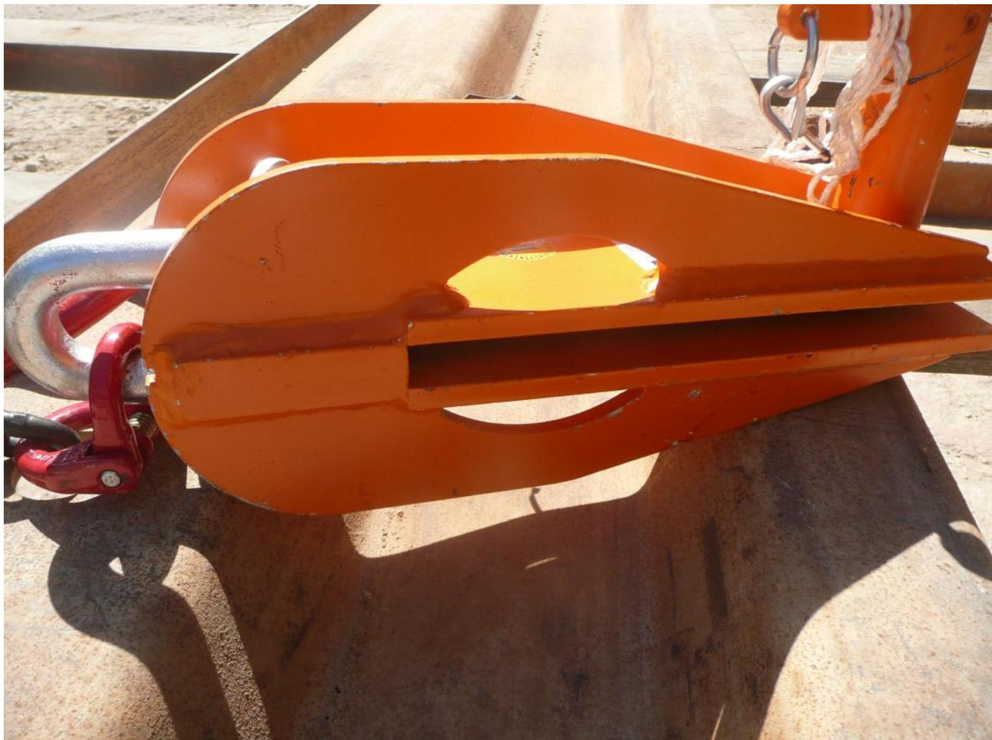
Accessoire obligatoire pour les travaux nécessitant de la manutention de palfeuilles ou palplanches, cette pince automatique sécurise le décrochage de la palfeuille ou la palplanche à distance.
